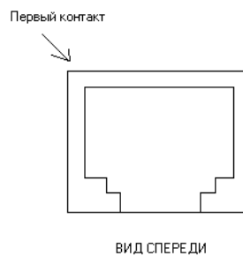
Рисунок 1. Вид и нумерация контактов разъема RJ-45
